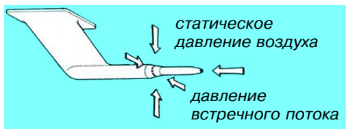
Рис. 2. Измерение полного давления в полете.
