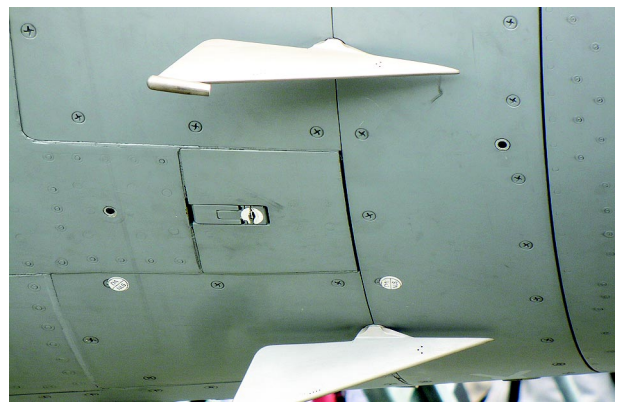
Так выглядит приемник внешнего давления. Примерно такие устанавливаются на всех самолетах.
